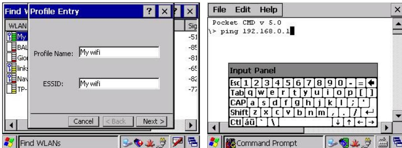
Debido a que la información de este dispositivo es volátil se debe exportar la configuración de la wi-fi a un archivo para que al iniciar el dispositivo configure automáticamente la red.
